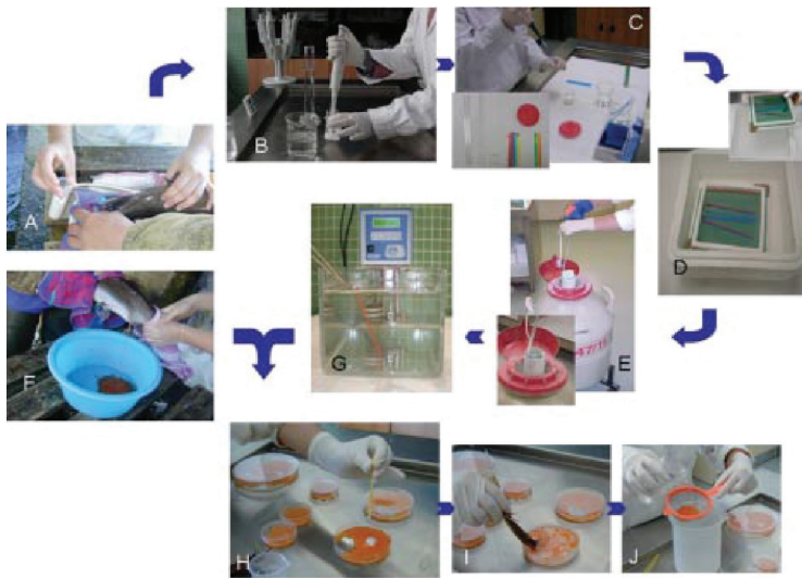
3.6 pav. Spermos šaldymo procesas: (A) upėtakių spermos išgavimas kaniuliacija, (B) praskiedimas krioprotektoriumi papildytu prailgikliu, (C) supylimas į 0,5 ml prancūziškus šiaudelius (įterptas su skirtingais šiaudeliais, kriovialais ir PVA milteliais sandarinimui), (D) šaldymas ant plūduriuojančio įtaiso polistireninėje dėžėje su skystu azotu \text{N}_2(\text{l}) , (E) laikymas \text{N}_2(\text{l}) talpykloje, (F) patelių ikrų išspaudimas, (G) atšildymas vandens vonelėje, (H–J) apvaisinimas (Fletcher & Rise, 2012)
